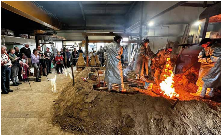
Der Glockenguss durch die Mitarbeiter der Firma Bachert.
