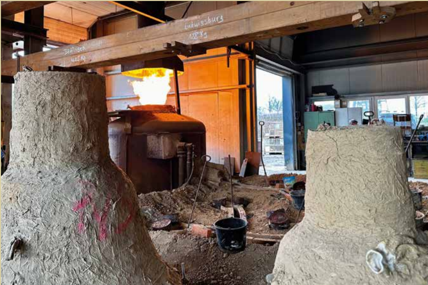
Schmelzofen mit Mantelglocken
